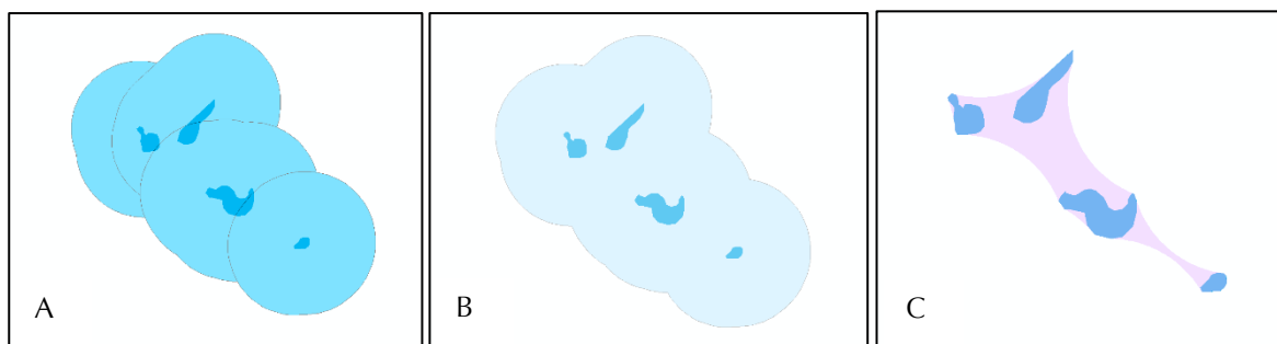
Figure 12. A- Tampon autour des zones impliquées dans le chemin ; B- Fusion des tampons ; C- Erosion permettant de visualiser le chemin le plus court © Antoine Larré, 2017.
